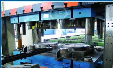
double-station blanking die
